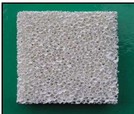
Obr. 17. Obrázok ukazuje pórovitú látku na báze oxidu hlinitého, pripravenú nanášaním vodnej suspenzie jemnozrnného \text{Al}_2\text{O}_3 na polyuretánovú penu a následným tepelným spracovaním pri 600\text{ }^\circ\text{C} a následne pri teplote 1600\text{ }^\circ\text{C} .
