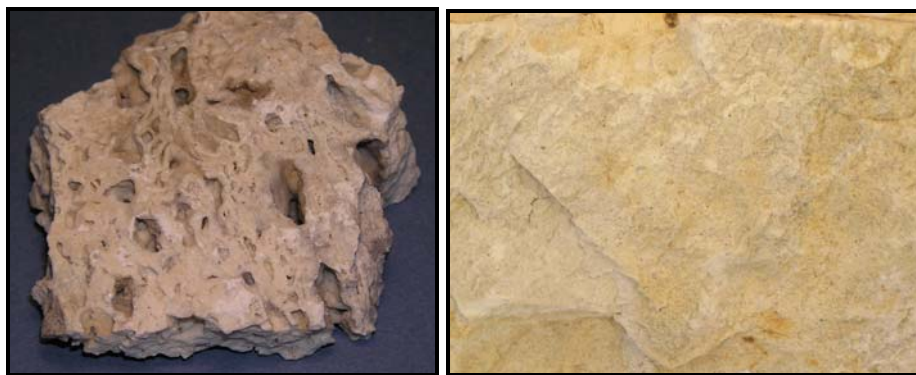
Obr. 5. Makropórovitá hornina travertín (vľavo) a mikropórovitý diatomit (vpravo).
