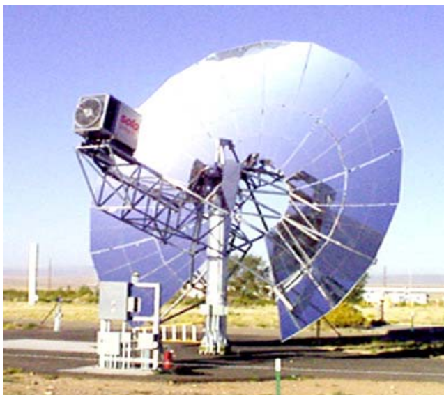
Obr. 3. Fungujúci prototyp stirlingového systému navrhnutého a inštalovaného v USA.
