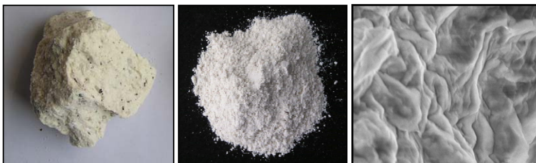
Obr. 2. Obrázok ukazuje monominerálnu vzorku ílového minerálu montmorillonitu (stred), jeho materskú horninu bentonit (vľavo) a zväčšenú snímku častice montmorillonitu (veľkosť objektu v zábere je 3\ \mu\text{m} \times 4\ \mu\text{m} ).
