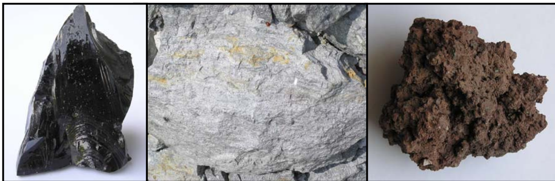
Obr. 4. Obrázok ukazuje nepórovité vulkanické sklo (vľavo), pórovitú pemzu (v strede) a vysoko-pórovitú stuhnutú lávu (vpravo).
