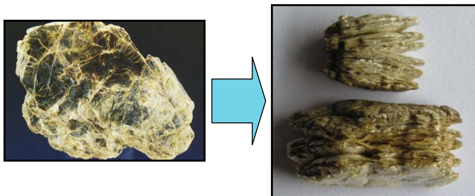
Obr. 13. Obrázok ukazuje fylosilikát vermikulit a jeho tepelne spracovaný produkt, v ktorom k vytvoreniu pórovitej štruktúry došlo vzájomným oddelením paralelne orientovaných silikátových vrstiev.
