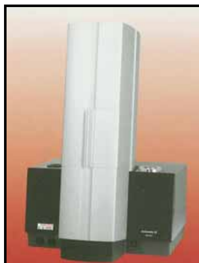
Obr. 18 Moderný laserový analyzátor Analysette 22 (FRITSCH GmbH) je schopný analyzovať partikulárne látky s veľkosťou častíc od 0,01 \mu\text{m} do 2000 \mu\text{m} .
