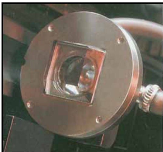
Obr. 15 Prietoková kyveta laserového analyzátora veľkosti častíc Analysette 22 od firmy FRITSCH GmbH.
