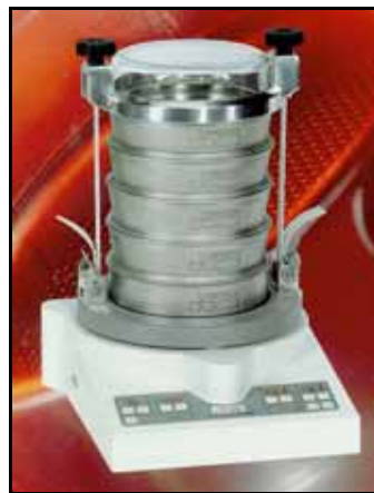
Obr. 4b Komerčné zariadenie firmy FRITSCH GbmH s vibračným podstavcom s regulovateľnou amplitúdou kmitov.
