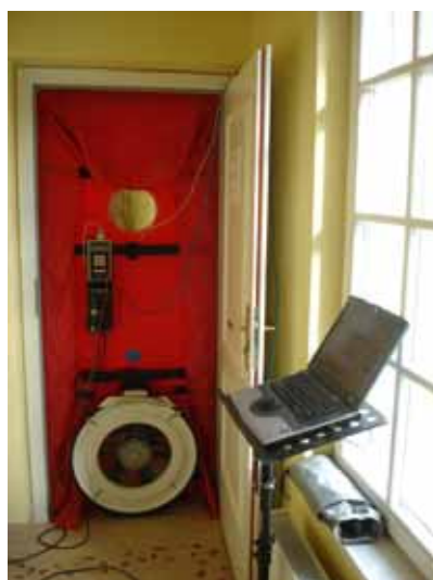
Obr. 5 BlowerDoor test Foto: Vladimír Šimkovic
