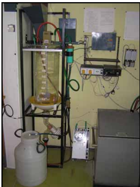
Obr. 2 Pohľad na hlavnú časť sedimentačného zariadenia
